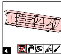
4. Absaugschacht reinigen
