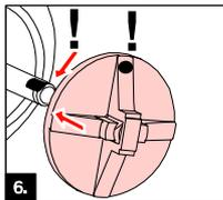
6. Montieren Sie den Mischquirl (Für die korrekte Position, achten Sie auf die Pfeile)
