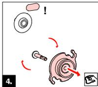
4. Demontieren Sie den Mischflansch und reinigen Sie die Achse und den Absaugschacht
