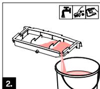
2. Leeren und reinigen Sie die Tropfschale
