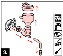
3. Demontieren und reinigen Sie die Mischeinheit
