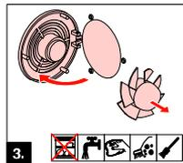
3. Ventilatorgitter und Propeller reinigen
