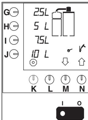
Fig. 3 Tableau de commande du système de filtration
